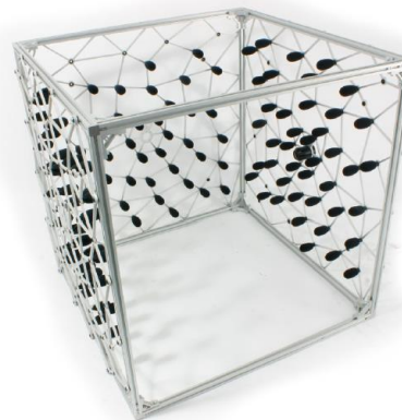
Exemple d'antenne 3D basée sur l'assemblage de 3 antennes Spider.
